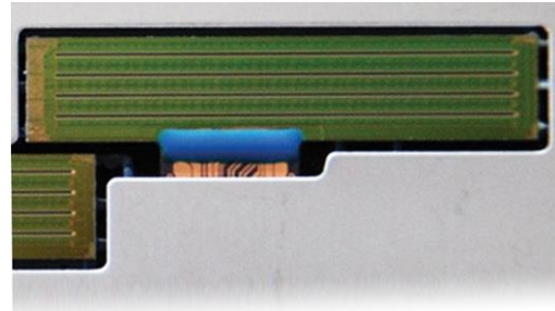
Abbildung 8. Nahansicht eines Dies im thermischen HP Tintenstrahlendrucker
