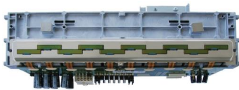
Abbildung 7. PageWide-Druckwerkbaugruppe, Ansicht von unten
